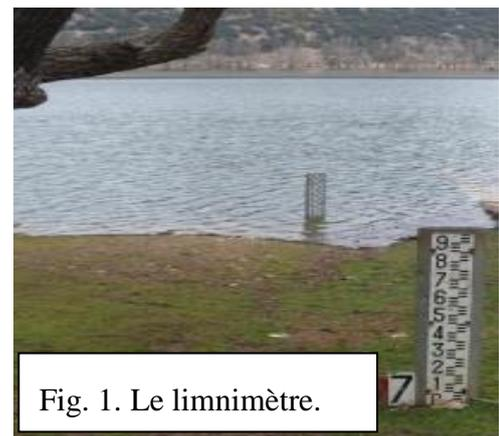
Fig. 1. Le limnimètre.
