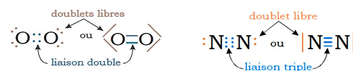
Partant de la notation de Lewis des atomes on écrit les *structures de Lewis* des molécules en représentant par un trait chaque paire d'électrons de liaison et par un point un électron célibataire.
