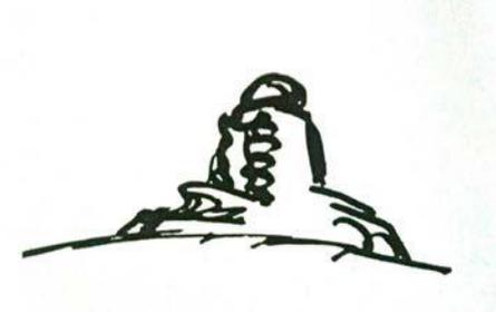
**Figure 06:** Esquisses par Mendelsohn de la tour Einstein, Potsdam, Allemagne, 1917. Les exigences structurelles ont peu d'influence sur la forme extérieure de ce bâtiment, bien qu'elles aient une influence sur l'aménagement intérieur. Étonnamment, il a été construit en maçonnerie porteuse.
