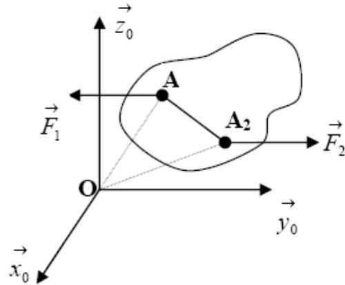
La somme des forces, est nulle mais le moment n'est pas nul. Un couple de force produit uniquement un mouvement de rotation. Le moment d'un couple est indépendant du point où on le mesure, il dépend uniquement de la distance qui sépare les deux droites supports des deux forces.
