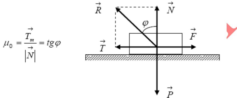
La force de frottement  $\vec{T}$  est dirigée dans le sens contraire du mouvement et l'angle  $\varphi$  est appelé angle de frottement statique.
