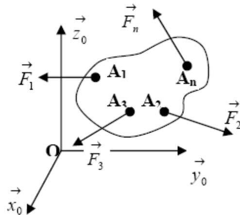
Un solide (S), soumis à des actions mécaniques extérieures est en équilibre statique si et seulement si le torseur représentant l'ensemble de ces actions est un torseur nul.
