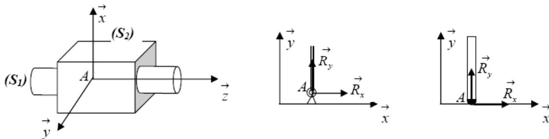
$$\vec{R}_A = \vec{R}_{Ax} + \vec{R}_{Ay} \quad \text{avec} \quad \vec{R}_{Az} = \vec{0}$$
