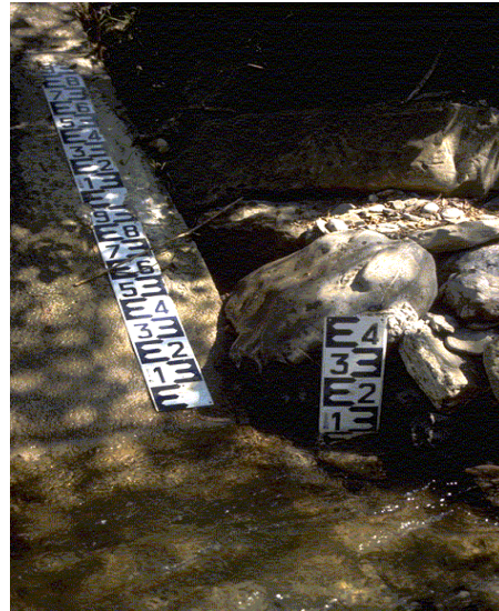
Figure 20. Echelles limnimétriques inclinée et verticale.
