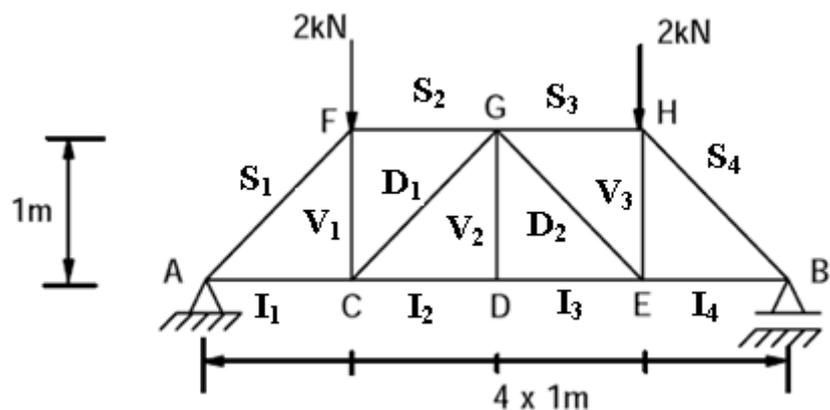
$L=3 \times 13 - 2 \times 18 - 3 = 0$  donc le système est isostatique.
