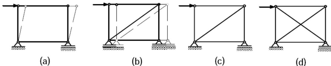
Le système indéformable est isostatique si les réactions d'appuis se déterminent à l'aide des seules conditions d'équilibre. Dans le cas contraire le système est dit hyperstatique. Pour déterminer la catégorie du système, on utilise l'étude cinématique qui peut être exprimée par la formule suivante:
