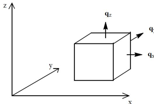
Fig. II.1 : Bilan des flux d'eau au travers d'un élément infinitésimal
