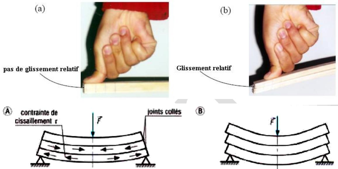
Pour l'exemple ci-dessus, les contraintes de cisaillement  $\tau$  qui s'exercent dans les joints collés assurent le maintien (évitent le glissement) entre les poutres respectives et limitent ainsi les déformations.
