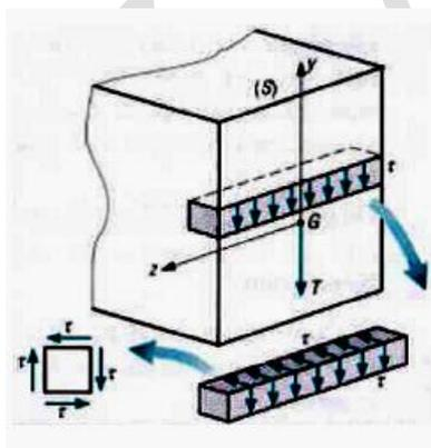
La figure ci-contre donne la distribution des contraintes de cisaillement dans une section droite (S) supportant un effort tranchant T.
