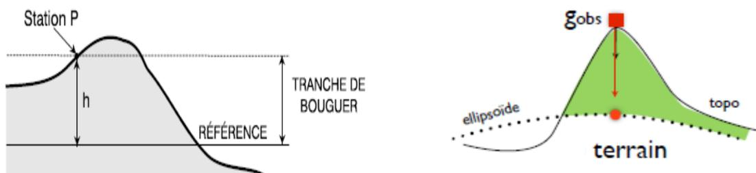
Au point P (voir figure ci-dessus), l'intégration sur les morceaux en trop et en manque est donnée par :
