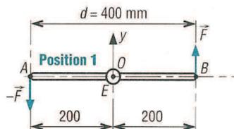
Quelle que soit la position de la tige de manoeuvre, le couple exercé par la clé sur l'écrou est identique :
