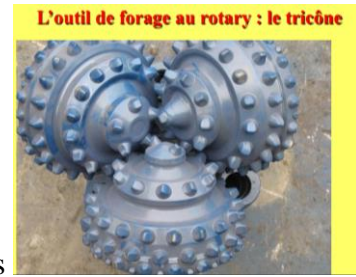
Fig. I.4a : Deux types courants de trépan :
