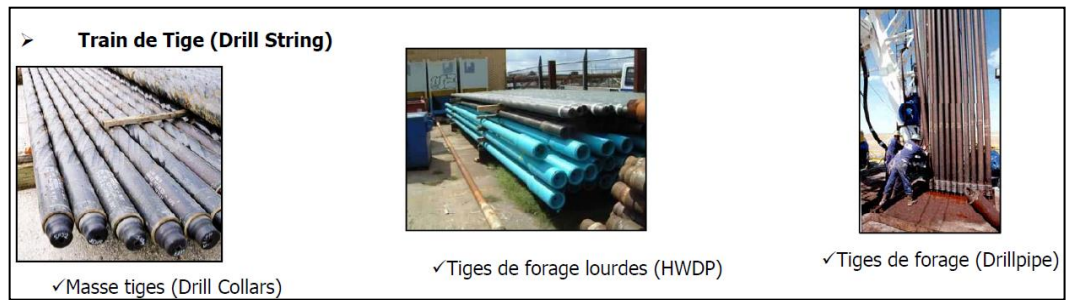
Fig. I.11. : Tiges, tiges lourdes et masse tiges, (Zatout, 2009)
