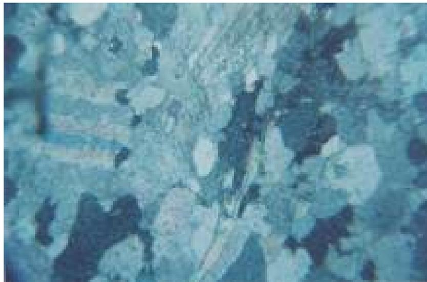
Un échantillon de marbre par microscope polarisé et diffraction
