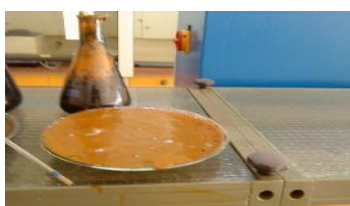
Figure 3. Diatomite modifiée par le fer (DMF4) après l'agitation et l'oxydation par l'air.
