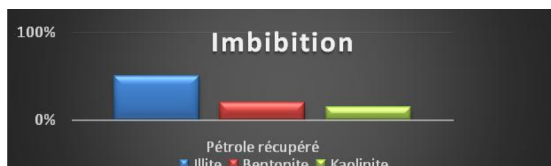
Figure 4 : les résultats des essais d'imbibition pour les 3 types d'argiles
