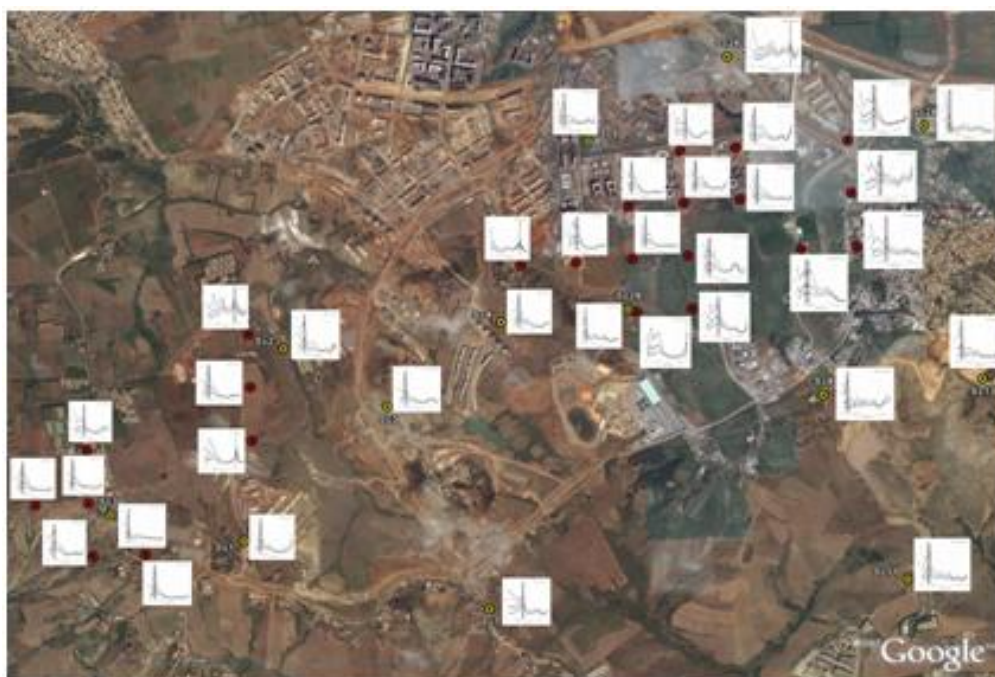
Figure 2. Distribution géographique des typologies de courbes H/V et identification des zones de typologie homogène.
